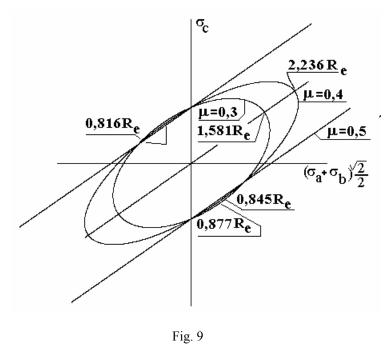
En el límite de elasticidad,  $\mu=0.3$  y el elipsoide corta el eje hidrostático en una distancia de  $1.581R_e$  del centro ( $\sigma_a=\sigma_b=\sigma_c=0.913R_e$ ) y el semi eje menor vale  $0.877R_e$ . Cuando  $\mu=0.4$ , dichos valores alcanzan  $2.2326R_e$  ( $\sigma_a=\sigma_b=\sigma_c=1.29R_e$ ) y  $0.845R_e$ , y cuando  $\mu=0.5$ , tenemos dos paralelas en una distancia  $0.816R_e$  del centro.
