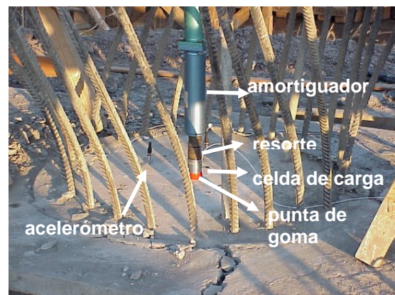
Figura 2: Mecanismo de aplicación de la carga
