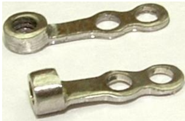
Figura 8: Plaquita distractora y plaquita base con las modificaciones antes de doblar
