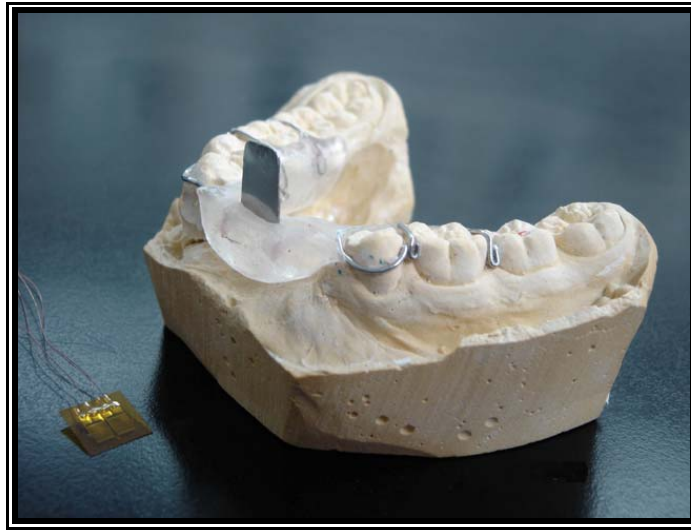
Figura 13. Férula colocada en la impresión para fijar las galgas y calibrar previo al montaje en el paciente
