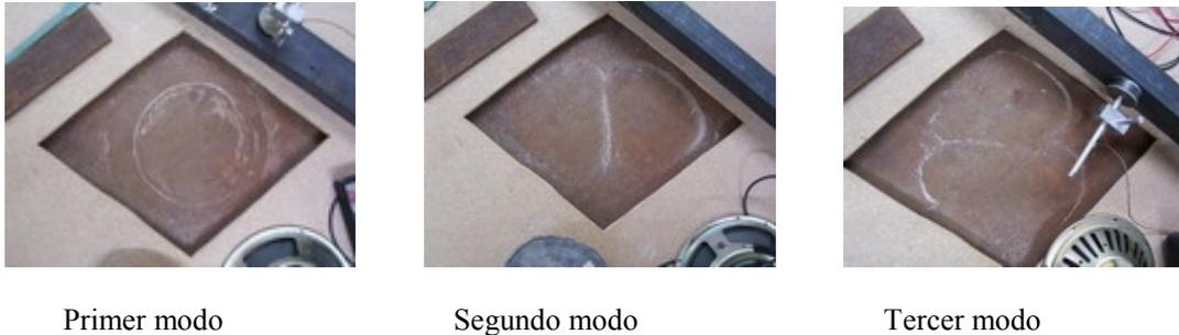
Figura 5. Ensayo experimental: formas modales.
