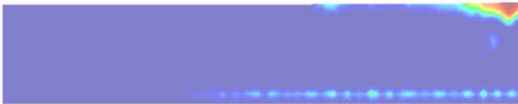
Figura 8: Esmagamento do concreto devido à compressão na viga
