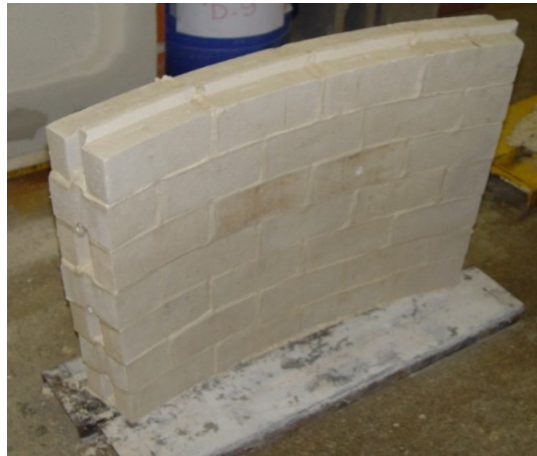
Figura 2 – Miniparede utilizada no ensaio.
