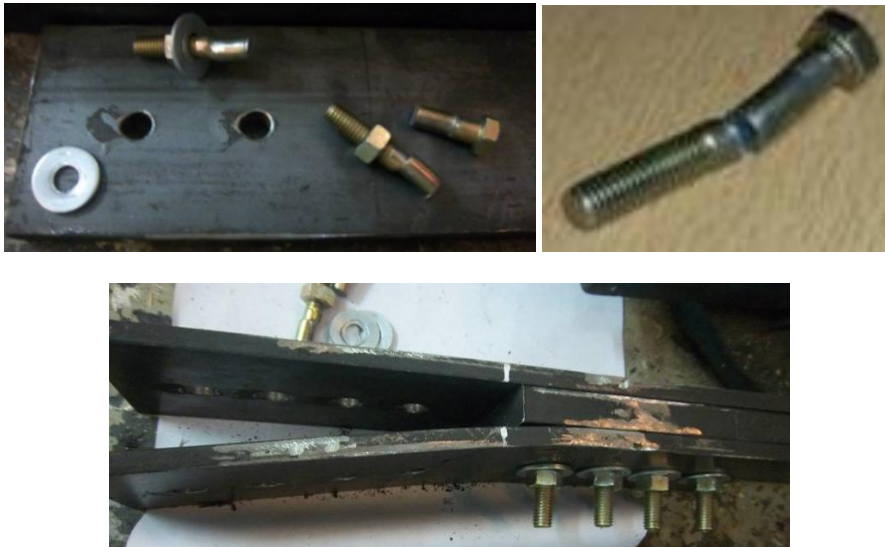
Figura 5: Tipo de falla de especímenes con dos y cuatro agujeros
