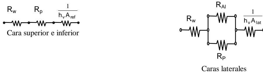
Figura 8: Circuitos térmicos equivalentes para el encofrado y aislación de la viga RG8
