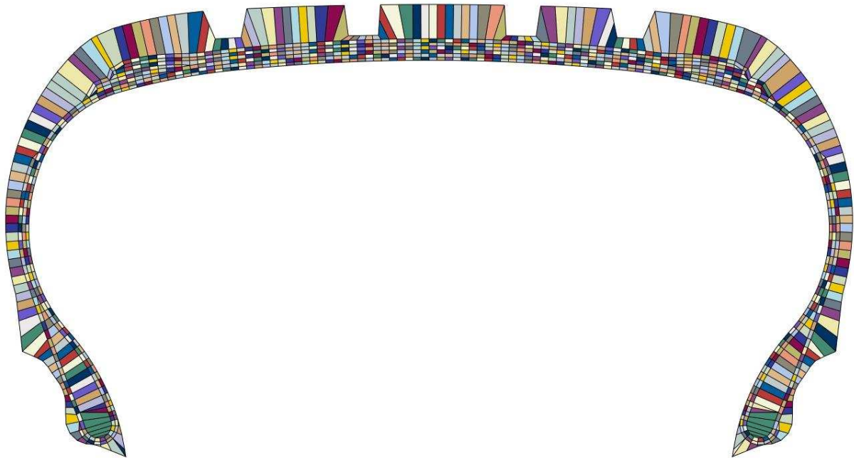
Figura 16: Distribución de propiedad de materiales según temperatura de elemento.
