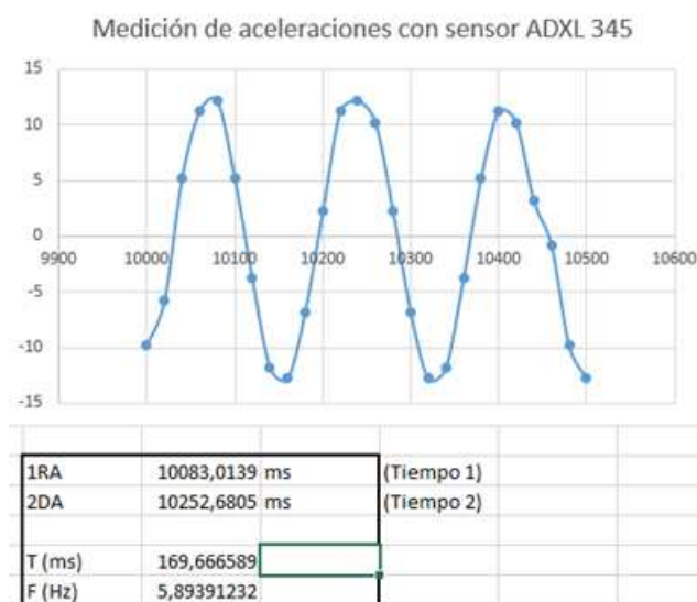
Figura 5: Gráfica de aceleraciones. Cálculo de frecuencia a partir de periodo calculado a partir de la onda graficada. Sensor colocado al final de la regla.
