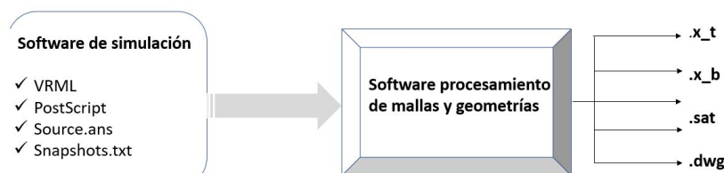
Figura 9: Esquema del proceso empleado para la obtención de la geometría CAD.
