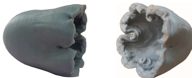
Figura 11: Impresión 3D del proyectil obtenido.
