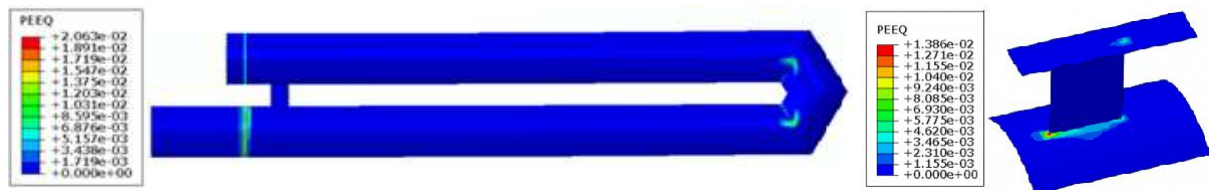
Figura 13: Deformación plástica equivalente (PEEQ), en todo el TDF, en el sector de unión del tubo con rigidizador y en la chapa (Tg=500°C).
