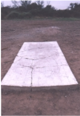
Figura 2 : Placa de hormigón ensayada bajo cargas explosivas a) Ensayo experimental, b) Resultado de la simulación numérica
